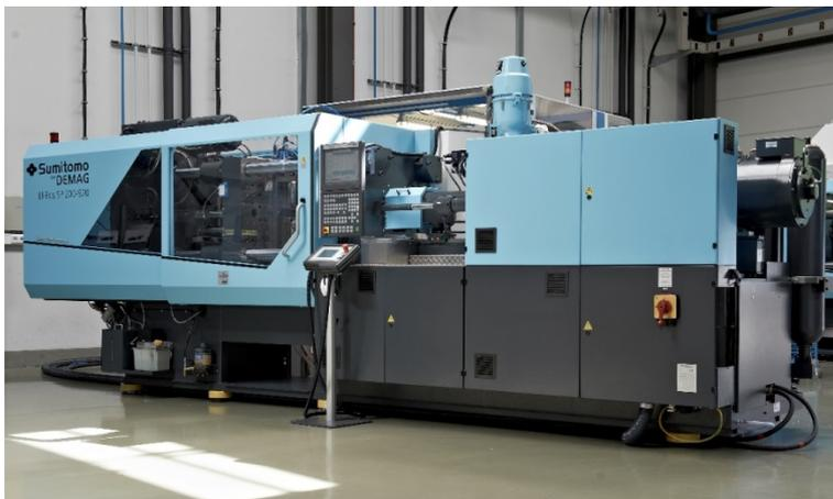
*Die EI-Exis SP ist speziell für schnelllaufende Verpackungsanwendungen konzipiert und bietet durch ihre hybride Antriebstechnik die beste Kombination aus Ausstoßrate, Energieeffizienz und Langlebigkeit.*
